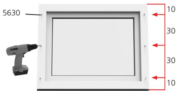
**4.2** Die Führungsschiene muss versetzt zur Endposition an dem Rahmen angebracht und danach auf ihre endgültige Lage hinter die Nase der Anschlagleiste geschoben werden.
